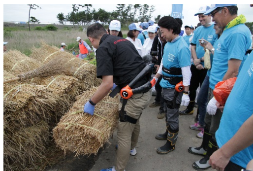
「HAL®作業支援用(腰タイプ)」を着用して運搬する様子
